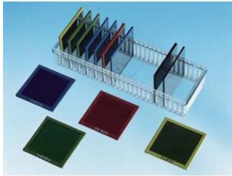
Laisse passer les rayons de faible longueur d'onde hors du spectre visible ; convient particulièrement bien au filtrage du rayonnement intensif ultraviolet du spectre du mercure.
