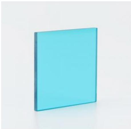
Le filtre de lumière vert BG39 bloque le rayonnement d'un laser (de pompage) au-dessus de 800 nm et laisse le rayonnement visible à 532 nm avec 80% efficiency. Le filtre est utilisé dans un diode laser à semi-conducteurs pour séparer le second harmonique à 532 nm du rayonnement laser et de la pompe.
