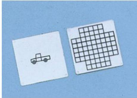
Objets de projection spécialement conçus pour l'étude d'images projetées et d'aberrations obtenues avec des miroirs et des lentilles ainsi que pour la détermination de l'échelle de l'image projetée dans le cas d'un agrandissement ; diapositives en verre acrylique.
