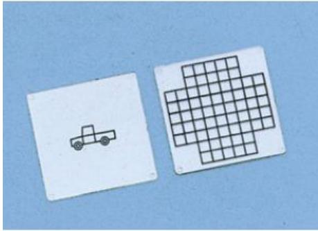
Objets de projection spécialement conçus pour l'étude d'images projetées et d'aberrations obtenues avec des miroirs et des lentilles ainsi que pour la détermination de l'échelle de l'image projetée dans le cas d'un agrandissement ; diapositives en verre acrylique.
