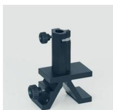
Cavalier pour banc d'optique à profil normalisé.
