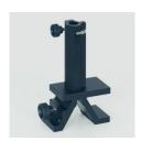
Cavalier pour banc d'optique à profil normalisé.
