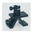
Cavalier pour banc d'optique à profil normalisé.
