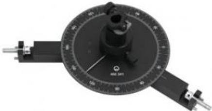
Pour relier deux bancs d'optique à profil normalisé, pourvue d'une colonne pivotante permettant le logement d'un composant optique. Mise en place possible d'un capteur de rotation S ( 524 082 ) pour mesurer l'angle formé par les rails.
