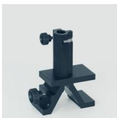
Cavalier pour banc d'optique à profil normalisé.
