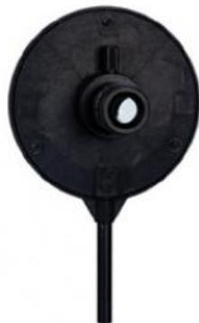
Oculaire avec échelle graduée, dans monture, pour mesurer une image dans un système optique, sur tige.
