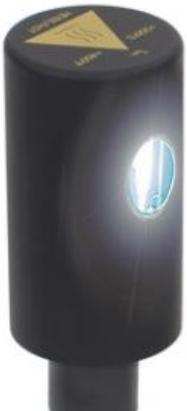
Source de lumière intense pour étudier le spectre du mercure, pour observer les phénomènes de fluorescence et l'effet photo-électrique ainsi que pour déterminer la constante de Planck.
