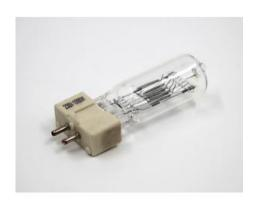
Caractéristiques: - Tension : 230 V - Puissance : 1000 W - Socle : GX9.5
