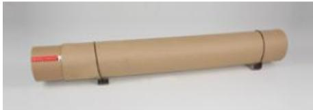
Dans un tube en carton à longueur variable (télescopique) avec échelle. Avec couvercle pour fermer le tube. En conjonction avec un haut-parleur (par exemple, 587 09, 587 08), les phénomènes de résonance peuvent être rendus acoustiquement audibles.
