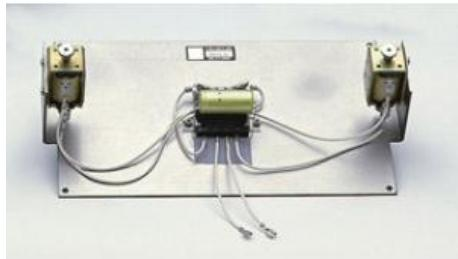
Permet d'arrêter simultanément la totalité des pendules du module de base ( 40120 /21) pour ainsi visualiser l'état instantané (figé) d'une onde.
