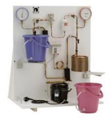
Pompe à chaleur avec mesure Pression et Température sur 2 manomètres
