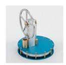
Moteur Stirling très maniable capable de fonctionner à partir d'un écart de température très faible, par ex. la chaleur de la main ; pour l'étude qualitative du cycle de Stirling.
