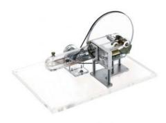
Pour létude expérimentale et les mesures dun cycle thermodynamique (cycle de Stirling).
