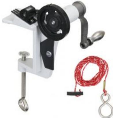
**Appareil de base pour déterminer l'équivalent mécanique de la chaleur**
