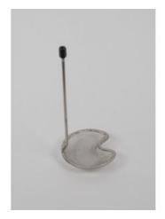
Porte-échantillon au couvercle du calorimètre 38421
