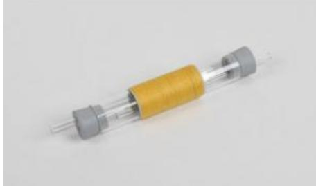
Pour obtenir des flux de vapeur sans eau de condensation lors de la détermination de la chaleur de condensation. Tube en verre isolé avec deux bouchons en caoutchouc percés et deux petits tubes en verre.
