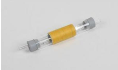
Pour obtenir des flux de vapeur sans eau de condensation lors de la détermination de la chaleur de condensation.
