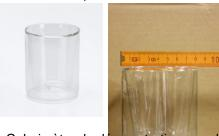
Calorimètre de demonstration pour la détermination des enthalpies de dissolution et de neutralisation. Récipient en verre à double paroi, sous vide, transparent et à fond plat pour la réalisation d'expériences sur
