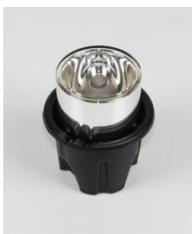
Sert de calorimètre si utilisé avec le couvercle (384 161) ou permet de déterminer l'équivalent électrique de la chaleur si utilisé avec le couvercle avec chauffage ( 384 20 ). Vase en verre à double paroi sous vide poussé, intérieur argenté, dans récipient en plastique.
