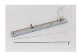
Permet la mesure exacte du coefficient de dilatation linéaire des solides en fonction du matériau, de leur longueur et de la température.
