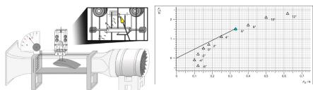
Profil d'aile et baroscope avec éléments de fixation pour la réalisation d'expériences sur la physique du vol dans la veine d'essais pour l'aérodynamique ( 37306 ) ou le tunnel aérodynamique ( 37312 ).
