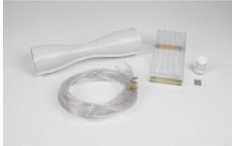
Pour l'étude de la pression statique à l'intérieur d'un tube à étranglement.
