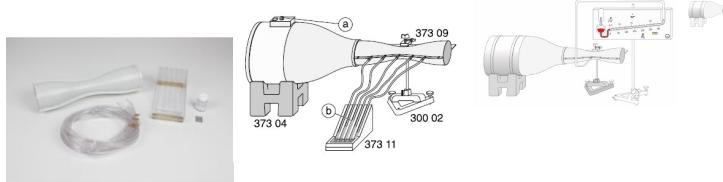
Pour l'étude de la pression statique à l'intérieur d'un tube à étranglement.
