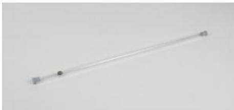
Pour la mesure du rapport cP/cV de l'air et d'autres gaz selon Rüchardt; convient également pour les expériences relatives au frottement interne des gaz; l'appareil est formé d'un tube en verre dans lequel coulisse une bille d'acier parfaitement ajustée.
