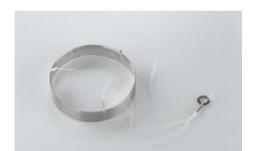
Dispositif de mesure de tension superficielle
