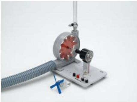
**Modèle centrale hydroélectrique (étude d'une turbine Pelton)**
