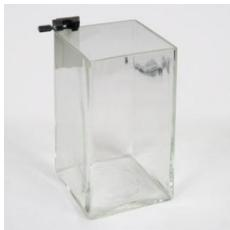
Récipient en verre stable avec noix, pour la fixation du manoscope ( 361 57 ) à différentes profondeurs d'immersion.
