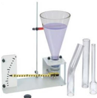
Pour mettre en évidence le paradoxe hydrostatique ; livré avec quatre vases en verre de forme différente.
