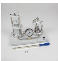
Pour la démonstration et l'étude quantitative de la transmission hydraulique des forces.
