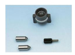
Billes d'acier montées dans un support à visser pour mesurer la dureté des métaux avec la presse hydraulique (
