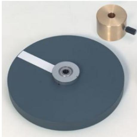
Avec masse de tarage (il y en a déjà une de fournie avec le gyroscope ( 348 20 ), pour l'étude des phénomènes gyroscopiques avec des disques gyroscopiques tournant dans le même sens et en sens contraire.
