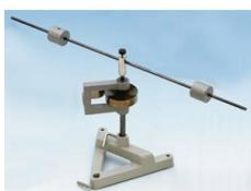
Pour l'étude des oscillations de torsion et la détermination des moments d'inertie de différents corps d'essai à partir de la période d'oscillation.
