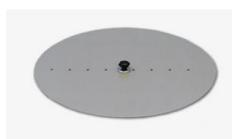
Permet de réaliser des mesures du moment d'inertie également pour des axes excentriques et de vérifier le théorème de Steiner.
