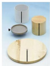
Pour déterminer expérimentalement les moments d'inertie.
