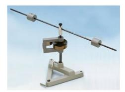
Axe de torsion pour l'étude des oscillations de torsion et la détermination des moments d'inertie
