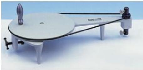
Pour produire manuellement un mouvement de rotation rapide. Système à poulie actionné par une manivelle. Mandrin à gorge ainsi que perçage axial et vis de serrage des deux côtés de la poulie. Livré avec courroie et étau pour le montage vertical.
