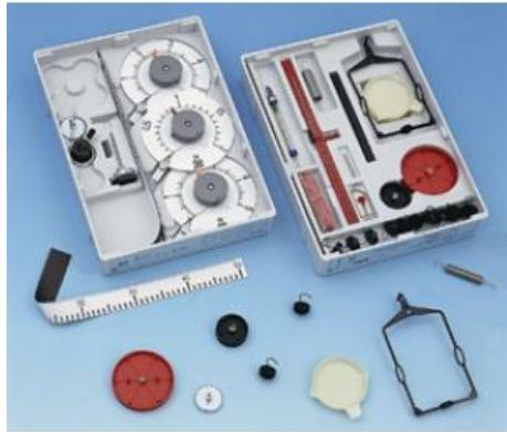
Matériel pour réaliser des expériences sur les « forces » et les « machines simples » sur le tableau magnétique ( 301301 ) monté dans le cadre d'expérimentation et de démonstration ( 301300 ).
