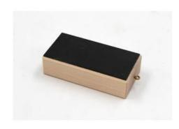
Bloc de bois pour les essais de frottement. Avec crochet latéral pour fixer un dynamomètre. Le frottement de glissement et d'adhérence de deux matériaux (bois, caoutchouc) peut être comparé. En outre, il est possible d'étudier l'influence en présence de surfaces de tailles différentes (bois).
