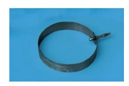
Avec fiche de 4 mm pour le montage sur un chariot pour rail ( 337 110 ). Convient notamment pour l'étude du choc, par ex. avec la caméra VidéoCom ( 337 47USB ).
