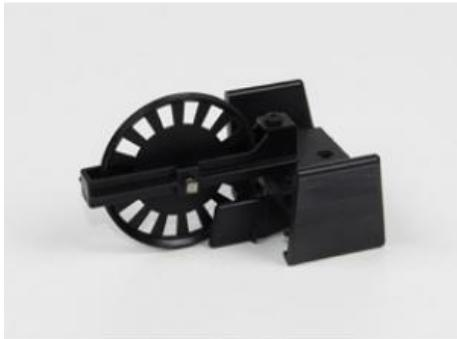
Pour des expériences sur le banc équipé d'un chariot et d'un rail métallique de précision ( 46081 ). Axe à pointe (presque sans frottement), faible moment d'inertie et guidage précis du fil dans la gorge. Ne convient pas pour les expériences sur le plan incliné. Rangement dans le plateau de l'enregistreur de temps ( 33718 ).
