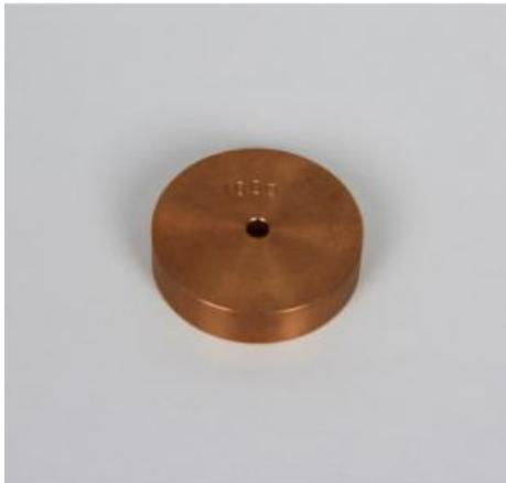
Pour l'étude des chocs avec le chariot de mesure ( 33700 ) pour doubler la masse totale accélérée. Rangement dans le plateau du chariot de mesure.
