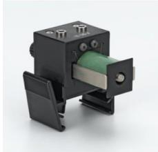
Électro-aimant pour le déclenchement d'un déplacement à un moment précis, par ex. à l'aide de l'adaptateur pour aimant de maintien avec déclencheur ( 336 25 ) ; avec noyau de fer à réglage axial pour la réduction des retards à l'aimantation. Se fixe sur un rail métallique de précision (par ex. 460 81 ) ; livré avec goupille pour le chariot pour rail.
