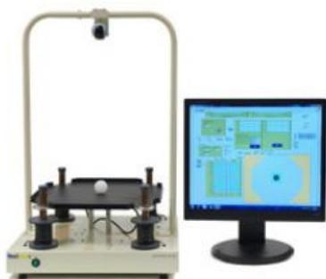
Le système de contrôle à billes et plaques est commandé par NI LabView et démontre un problème de contrôle classique: équilibrer une sphère sur une surface plane et maintenir sa position (version NI LabVIEW, y compris la carte d'interface NI LabVIEW et le câble).
