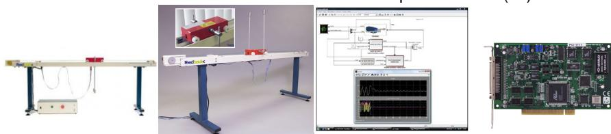
Le pendule numérique est une version moderne d'un problème de contrôle classique: le redressement et la stabilité d'un pendule à oscillation libre (pendule inversé) ou le contrôle de mouvement d'un pendule suspendu (application pour MATLAB, avec carte d'interface MATLAB et câbles)
