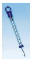
Dynamomètre, 5 N, transparent, calibré
