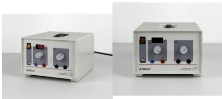
Alimentation électrique standard pour étudiants avec tension de sortie CC réglable et régulée en continu, tension CA réglable par étapes et affichage numérique.
