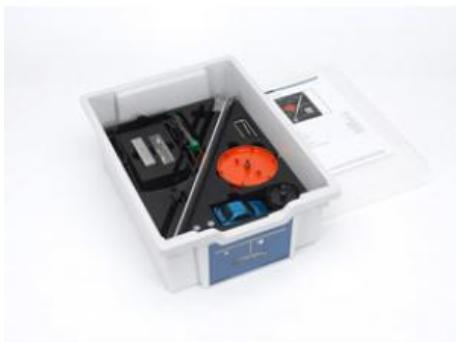
Équipement complémentaire pour la réalisation d'expériences fondamentales en mécanique, par ex. pour l'étude des thèmes suivants : volumétrie et densimétrie, loi de Hooke, balance à fléau, palan, pendule, définition de la vitesse ; dans boîte en plastique avec couvercle et insert thermoformé à la forme des composants.
